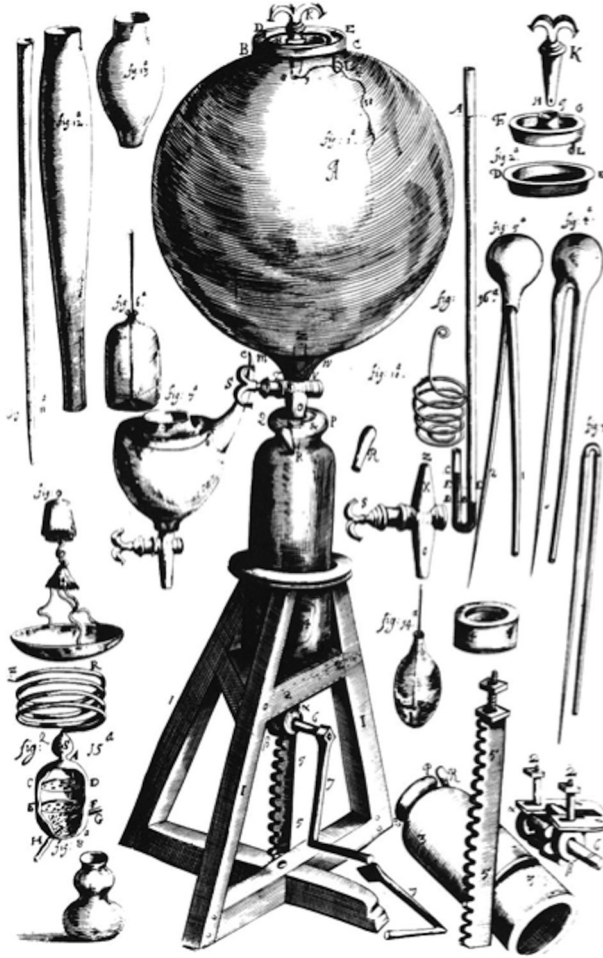
Fig. 6. Robert Boyles första lyckade luftpump, även kallad pneumatisk maskin ( pneumatical engine ) eller helt enkelt machina Boyleana. Den krävde inte nedsänkning i vatten som von Guericques tidigare hade gjort och gav förutsättningarna till 43 olika experiment genom att olika saker som barometrar och klockor kunde föras in i det evakuerade utrymmet. Ur Robert Boyle, New Experiments Physico-Mechanical (1660).
