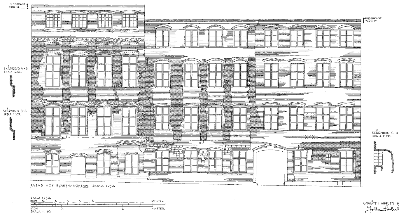
Fig. 6. Fasaden mot Svartmangatan av Kontrollstyrelsens hus kv. Cepheus 2 och 3. Uppmätning av J. Söderberg, sedan putsen avknackats. Längst till vänster "norra huset" (Cepheus n:r 2); i mitten "mellanhuset" och längst till höger "södra huset" (de båda sistnämnda tillsammans Cepheus n:r 3). De mörkare partierna äro de bevarade resterna av medeltidsfasaderna.
