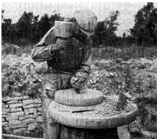
Fig. 18. Upphuggning av centrumhålet.
