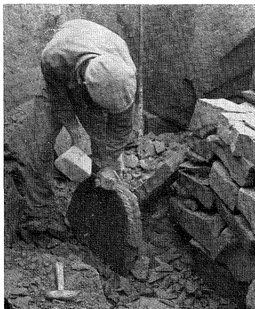
Fig. 13. Slipstensämnets kant spetsas med spetsjärn och klubba .
