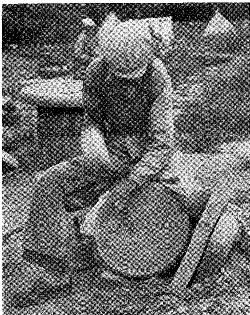
Fig. 20. Sislägersidan rivs upp med spetsjärn och klubba.
