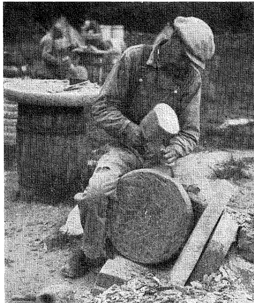
Fig 17. Huggning av kanten med stenen placerad på den av snedställda hållar bestående kantställningen.
